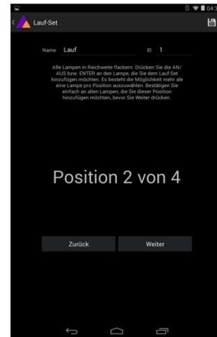
Jetzt blinken die Lampen im 2-Sekunden Takt. Um eine Lampe der angezeigten Position zuzuordnen, drücken Sie eine Bedientaste an der jeweiligen Lampe. Gehen Sie die Positionen mit "+1" und "-1" durch und ordnen Sie Ihre Lampen zu. Nach Fertigstellung speichern Sie oben rechts.
