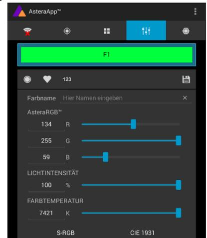
Bei Steuerung per DMX ist es möglich, alle Farben einzeln zu kontrollieren. Beachten Sie aber, dass die Temperaturkompensation in diesem Fall nur bei Rot, Grün und Blau aktiv ist. Bei Weiß kommt es zu einem Temperaturdrift und die Helligkeit kann nicht konstant gehalten werden.
