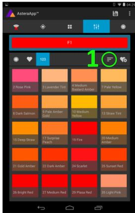
"123" bietet eine Farbauswahl. Diese kann mit der Sortierfunktion(1) nach Farben oder Nummern sortiert werden.
