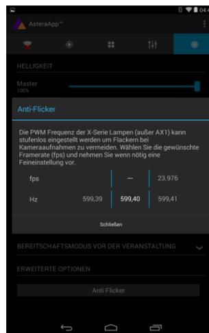
Verschieben Sie "fps" um Standardwerte einer Bildfrequenz einzustellen. Mit „Hz“ nehmen Sie die Feineinstellung vor.
