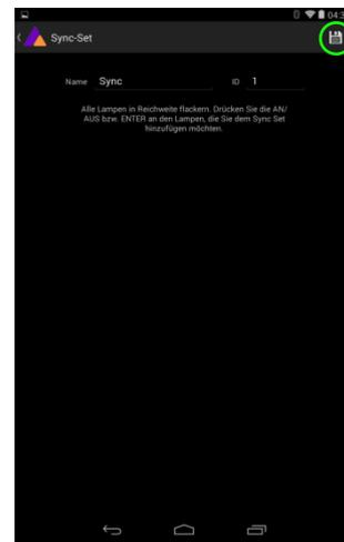
Jetzt blinken alle Lampen im 2-Sekunden Takt. Durch Betätigen der ENTER-Taste an der Lampe wird sie dem Set hinzugefügt (Kapitel 6.9). Zusätzlich kann ein Name für das Set eingegeben werden. Um Ihre Einstellungen zu speichern, drücken Sie das Speichersymbol rechts oben.
