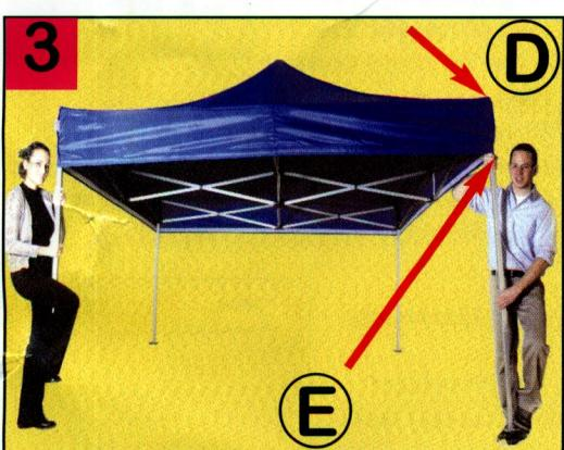
3. Zeltgestell ganz öffnen. Eine Hand auf Position D und mit der anderen Hand auf Pos. E legen, Gleitteil soweit nach oben schieben, bis der Druckknopf im Loch des Teils (F) einrastet (4 x, an jede Ecke, Zelt ist jetzt gespannt)
