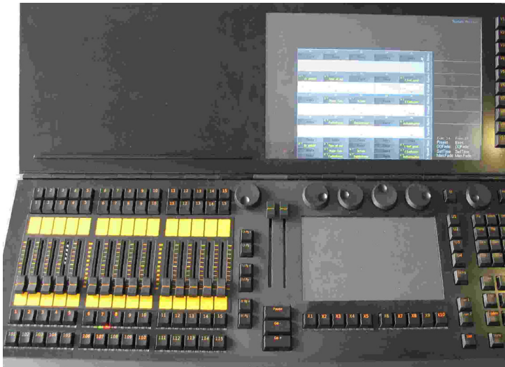
light / ultra-light: die Fader 1 - 10 werden auf dem Monitor angezeigt, die Fader 11 - 13 sind nicht aktiv; die Fader 14 und 15 fungieren als Preset- und Executorfader „Set Time / Man Fade“
