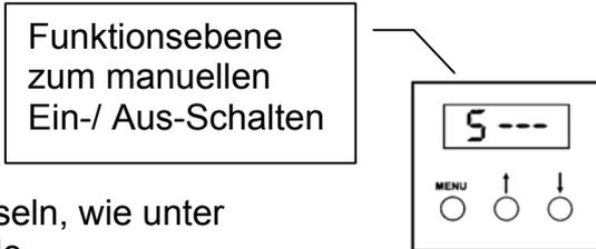
Befindet man sich im „S“-Menü wie Schalten, gelangt man durch erneutes Drücken der Taste „MENU“ in die Umschalt-Funktion. Das Ein- und Ausschalten des Verbrauchers erfolgt mit dem Drücken der Pfeiltasten. Die Pfeiltaste ↑ schaltet den Verbraucher ein, die Pfeiltaste ↓ schaltet den Verbraucher aus.
