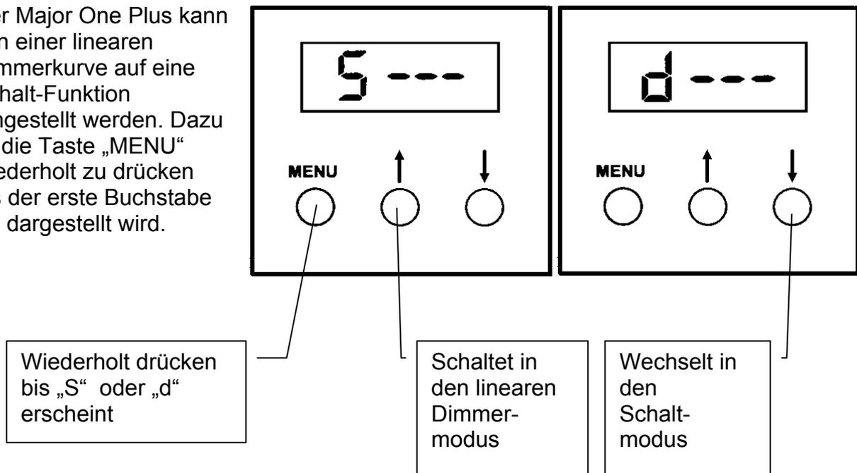
Befindet sich der Major One Plus bereits in der Schaltfunktion, so wird durch wiederholtes Drücken der Taste „MENU“ der erste Buchstabe als „S-on“ oder „S-of“ dargestellt.
