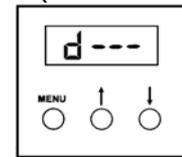
Befindet man sich im „d“-Menü wie „Dimmen“, gelangt man durch erneutes Drücken der Taste „MENU“ zunächst in das Limit-Menü und nach erneutem Drücken der Taste „MENU“ zur Pegeleinstellungs-Funktion. Das stufenlose Dimmen des Verbrauchers erfolgt mit dem Drücken der Pfeiltasten. Die Pfeiltaste ↑ erhöht die Ausgangsleistung innerhalb von Prozentschritten, die Pfeiltaste ↓ dimmt den Verbraucher herunter.
