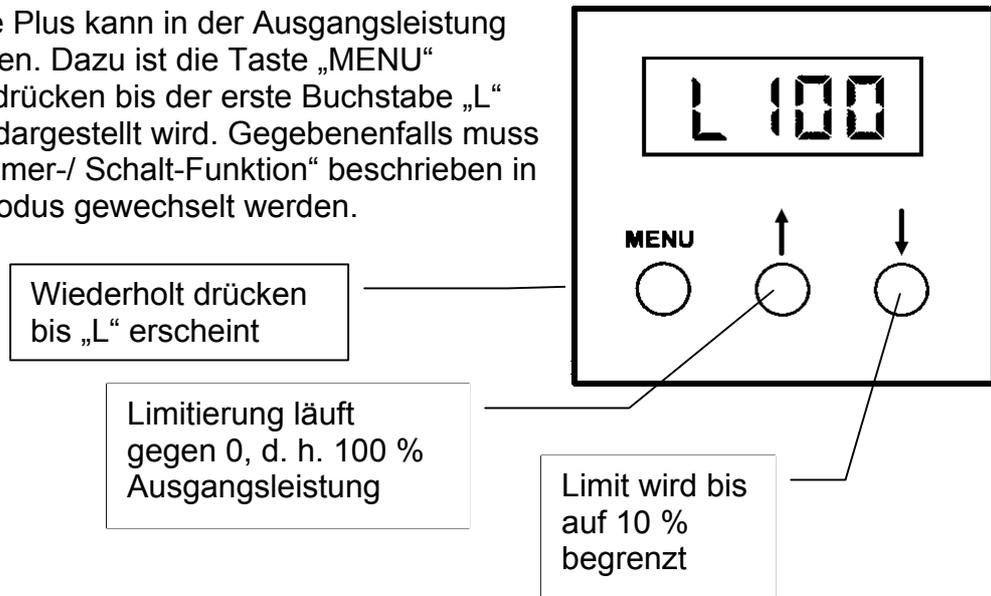
Das Erhöhen oder Senken der Ausgangsleistungsbegrenzung erfolgt mit dem Drücken der Pfeiltasten. Die Pfeiltaste ↑ minimiert die Begrenzung, die Pfeiltaste ↓ begrenzt die Ausgangsleistung.
