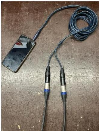
Die Signalquelle (Handy) kann nun über das Adapterkabel an die zugehörigen 3-pol XLR Kabel angeschlossen werden.
