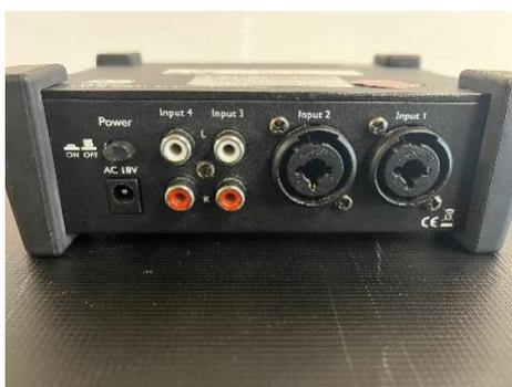
Auf der anderen Seite des Mixers kann man nun seine Signalquelle anschließen. Auf der Seite der Outputs kann man dann auch deren Lautstärke über Drehregler einstellen.
