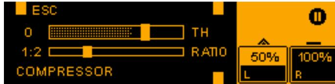
**i** Der gepunktete Bereich im Slider **TH** zeigt den Pegel des Audiosignals an.
