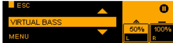
Unten links im Display wird die geöffnete Menüebene bzw. der geöffnete Menüpunkt angegeben. Über die **ESC**-Funktion können Sie in die vorherige Menüebene zurückwechseln.
