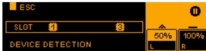
Die Geräteerkennung wird durchgeführt und im Display wird angezeigt, in welchem Erweiterungsschacht ein Gerät mit Mediensteuerungsprotokoll erkannt wurde.
