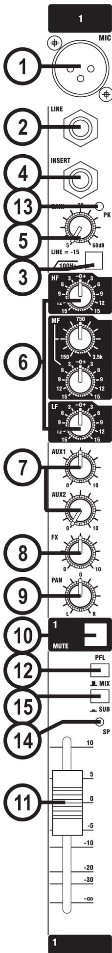
Das Send-Signal kann als alternativer Direktausgang vor dem Fader und der Entzerrung (pre-fade, pre-EQ) abgegriffen werden; dazu ist ein Kabel nötig, bei dem Spitze und Ring kurzgeschlossen sind, um den Signalfluß nicht zu unterbrechen (S.U.).
