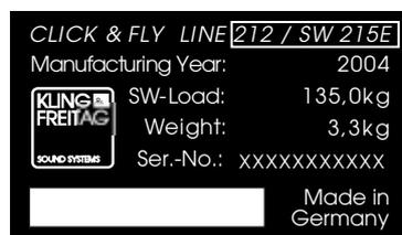
An dieser Position muss ‚LINE 212 / SW 215E‘ stehen. Wenn an dieser Position ‚RIGGING SYSTEM‘ steht, so ist das Click & Fly ausschließlich für die Verwendung mit Line 212 Systemen zugelassen.
