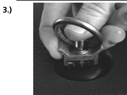
Führen Sie den Flachkopf des Haltebolzens in die Führung des Flugpunktes.
