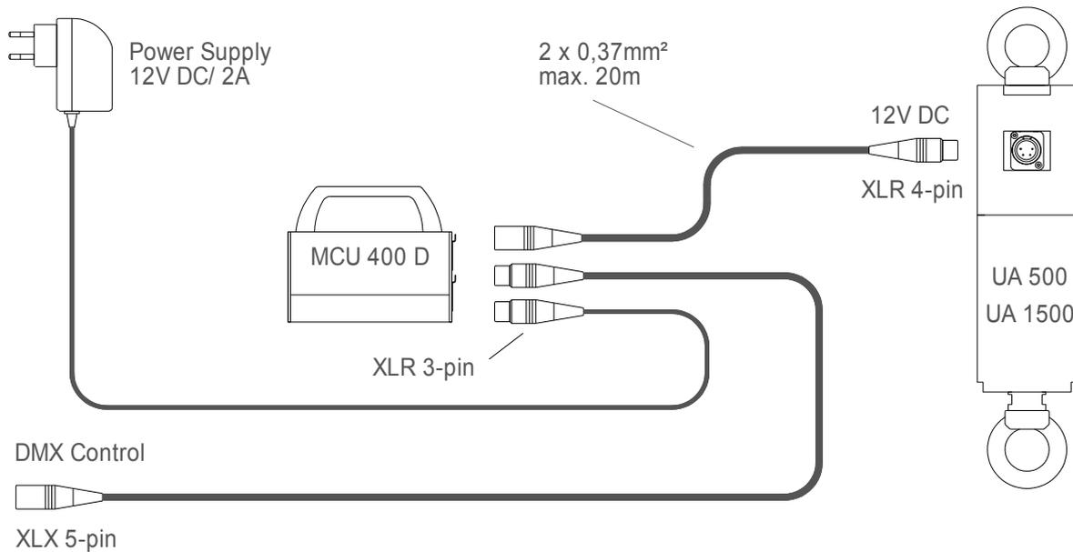
Bitte beachten Sie, dass die maximale Kabellänge vom Controller bis zum Motor nicht mehr als 20 m betragen sollte. Als Kabelsorte empfehlen wir Mikrofonkabel oder ähnliches.
