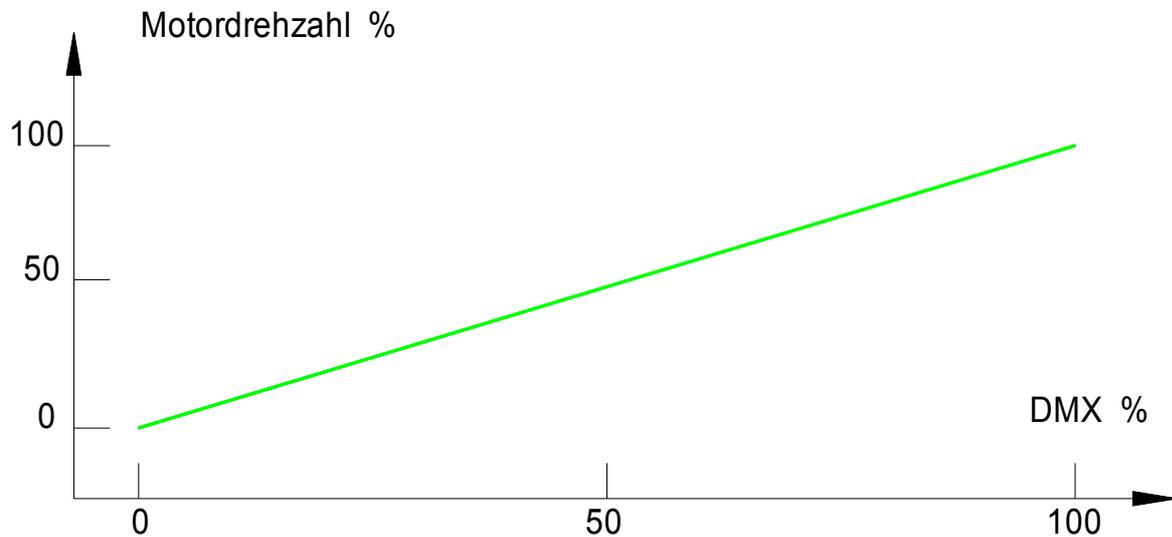
Die DMX Startadresse steuert die Drehrichtung. Die daraufhin folgende Adresse steuert die Geschwindigkeit des Motors. DMX Wert 0 entspricht Stillstand. Die Kennlinien dieser Betriebsart verläuft wie oben gezeigt linear. Bei Ausfall des DMX-Signales wird der Motor abgeschaltet (keine „HOLD“ Funktion).
