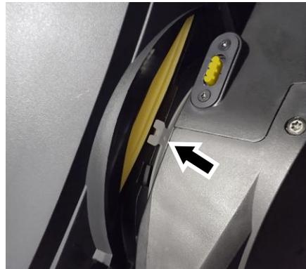
2. Siehe Abbildung oben. Ein Kippeinsatz sitzt um den Kippzapfen auf jeder Seite des Bügels. Die Kippeinsätze müssen nur beim Abnehmen der Bügelabdeckung entfernt werden - beim Abnehmen und Wiederanbringen der Kopfabdeckungen sollten Sie sie in Position lassen. Sie müssen jedoch darauf achten, dass die Laschen (Pfeil) in den Einsätzen auf beiden Seiten des Bügels *in die* Kopfabdeckung passen, wenn Sie die Abdeckung wieder anbringen. Siehe Abbildung unten.
