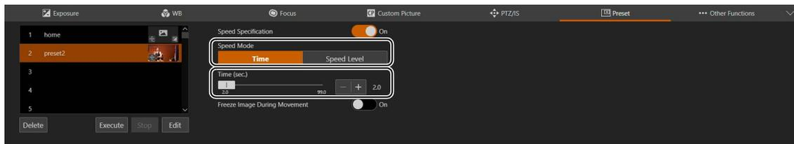
Wenn Sie eine Geschwindigkeit angeben, die von der bei der Registrierung der Voreinstellung eingestellten Geschwindigkeit abweicht, wählen Sie [Time] (Zeit) oder [Speed Level] (Geschwindigkeitsstufe).
