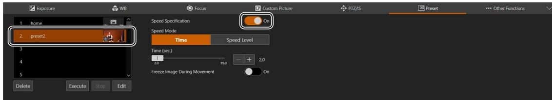
Setzen Sie [Speed Specification] (Geschwindigkeitsspezifikation) auf [Off] (Aus), um die Geschwindigkeitsstufe zu verwenden, die beim Registrieren der Voreinstellung festgelegt wurde.
