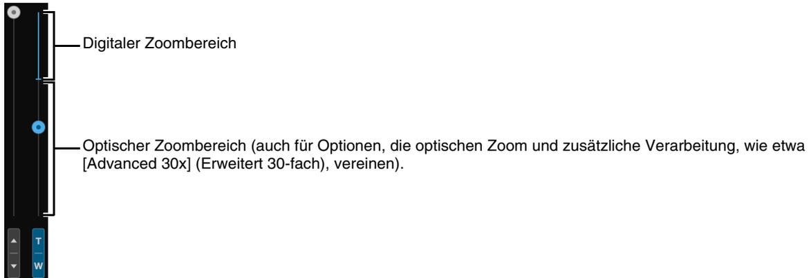
Wenn [PTZ/IS] > [Digital Zoom] (PTZ/IS > Digitaler Zoom) auf [Digital Tele-Converter] (Digitaler Telekonverter) (S. 46) eingestellt ist, wird das Video entsprechend der eingestellten Vergrößerung vergrößert; die Position des Schiebereglers bleibt jedoch unverändert.
