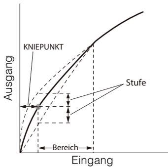
[Knee: Active] (Knie: Aktiv), [Knee: Automatic] (Knie: Automatik), [Knee: Slope] (Knie: Steigung), [Knee: Point] (Knie: Punkt), [Knee: Saturation] (Knie: Sättigung)
